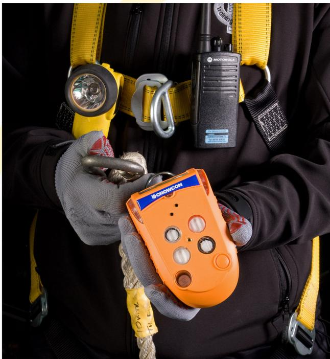
Creato appositamente per l'utilizzo come dotazione personale di sicurezza per chi lavora in spazi confinati a rischio, il rivelatore multigas Gas-Pro consente di misurare in continuo fino a 5 gas contemporaneamente, scegliendo tra una vasta gamma di sensori differenti.
